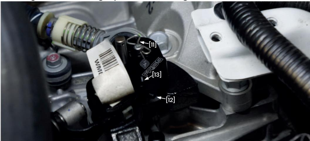
23. Sicherungsschraube seitlich (SW2,5) [12] leicht anziehen
