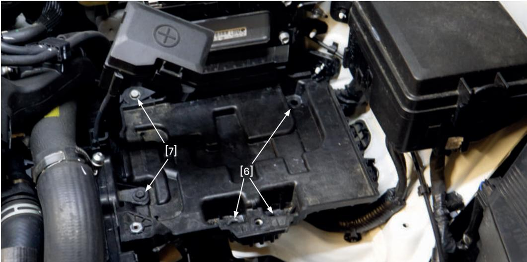
16. Batterieplatte entfernen
