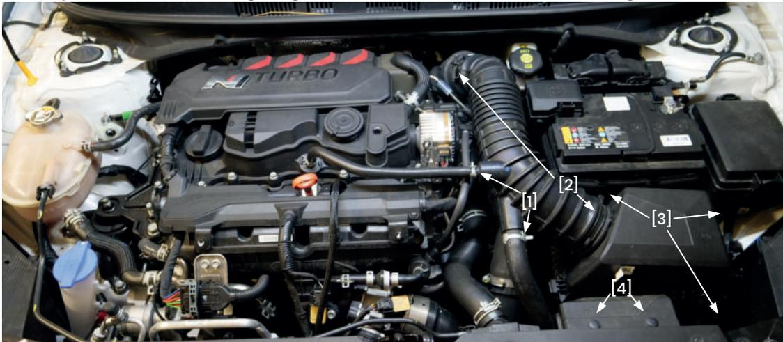
5. Luftfilterkasten nach oben herausziehen
