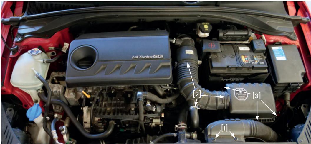
6. Luftfilterkasten nach oben herausziehen
