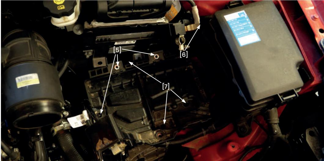
16. Batterieplatte entfernen
