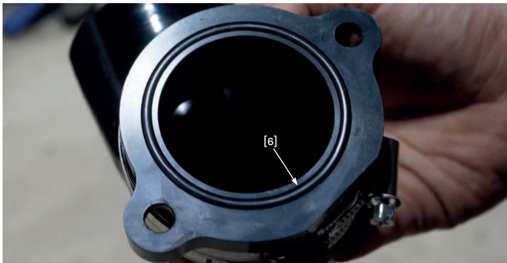
10. Foresight Führungsschlauch mit beigelegten Schlauchschellen aufschieben
