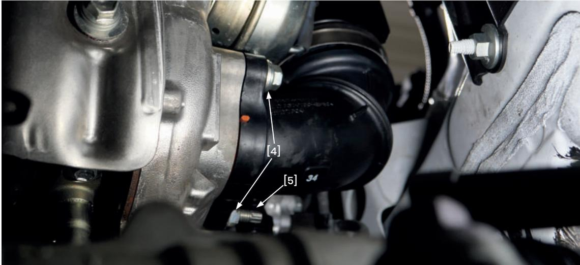
9. Foresight Turbo Inlet mit mitgelieferten Schrauben [7] (Inbus 6) festschrauben (Auf beigelegte Dichtung [6] achten!)
