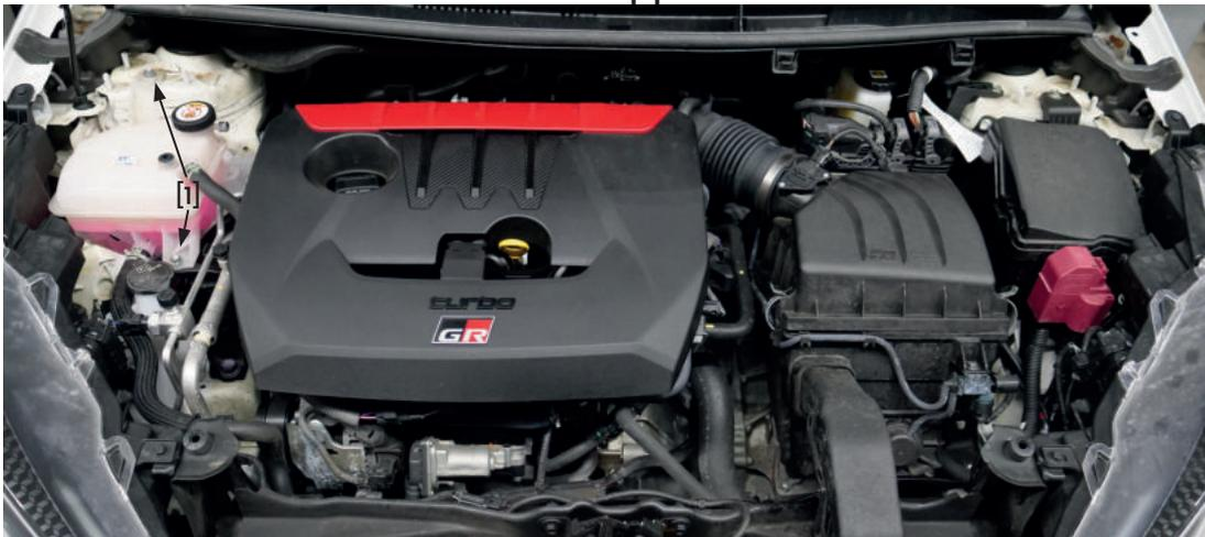
4. Schraube [2] (SW10) am Ansaugrohr im Motorraum lösen
